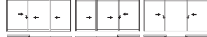
突合せタイプ (外・内・内) 突合せタイプ (内・内・外) 両袖タイプ* (外・内・外)
